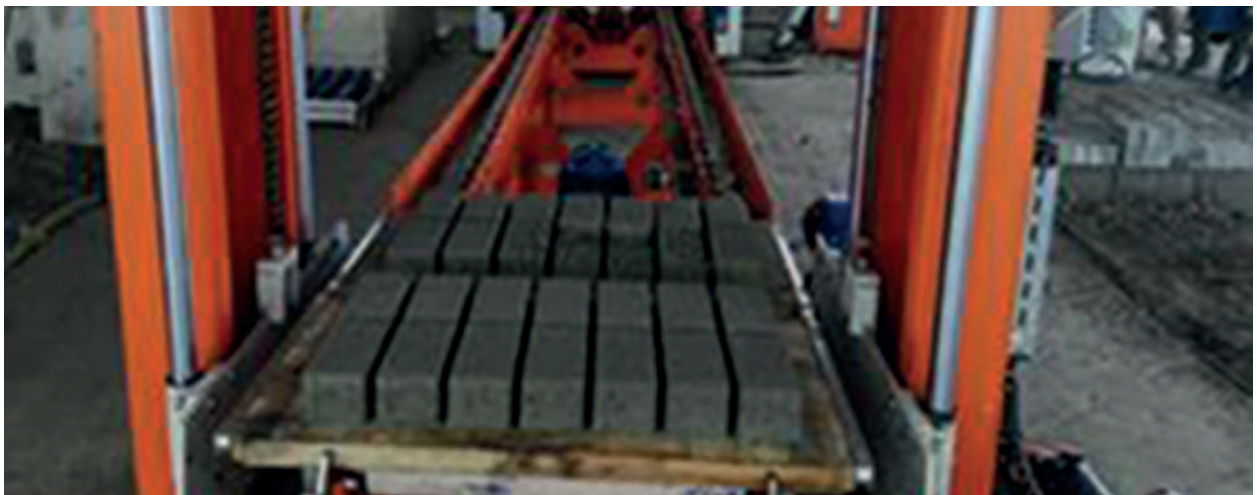
Ladrillos y bloques elaborados a partir de la escoria blanca de los procesos siderúrgicos por parte de Gerdau Diaco.
